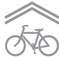
Marquage avec double-chevron
